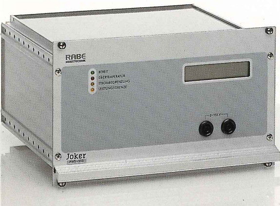
PWS-250: Regel-Trenntrafo 0 bis 255 VAC, Leistung 500 VA
